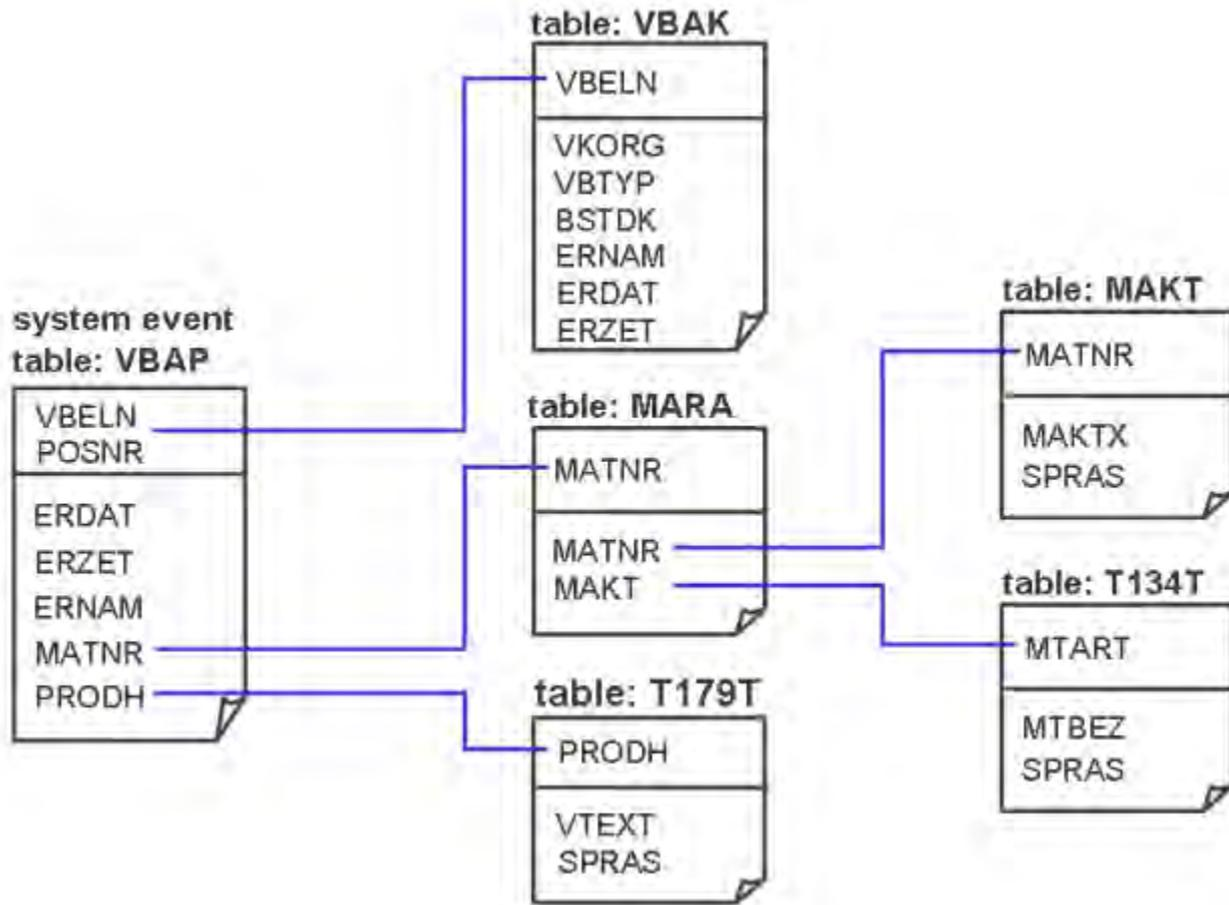
Es muss eine Tabelle definiert werden, bei der für jede gelesene Datenzeile ein PPM-System-Event erzeugt werden soll. Im Beispiel soll für jede im Januar 2006 neu angelegte oder geänderte Verkaufsbelegposition, die in der SAP-Tabelle VBAP enthalten ist, ein PPM-System-Event erzeugt werden. Zusätzlich sollen zu jeder Verkaufsbelegposition die entsprechenden Zeilen und Felder der anderen Tabellen ausgelesen werden. Die zugehörige Konfiguration sieht im CTK bzw. in XML folgendermaßen aus:
