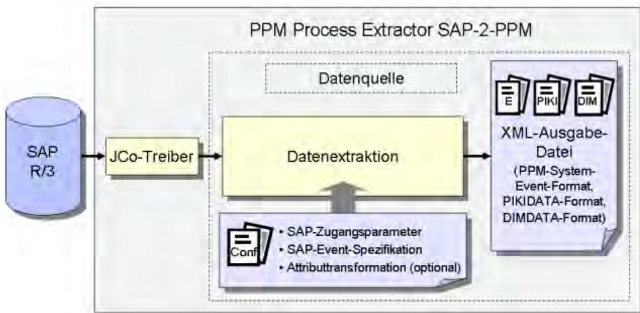
Der SAP Java Connector (SAP JCo) wird verwendet, um mittels SAP-Zugangsparameter die Verbindung zum SAP-System aufzubauen. Danach werden Daten aus den SAP-Tabellen gemäß der SAP-Event-Spezifikation extrahiert. Abschließend erfolgt eine optionale Attributtransformation und Ausgabe der Daten in XML-Dateien eines PPM-kompatiblen Ausgabeformats.
