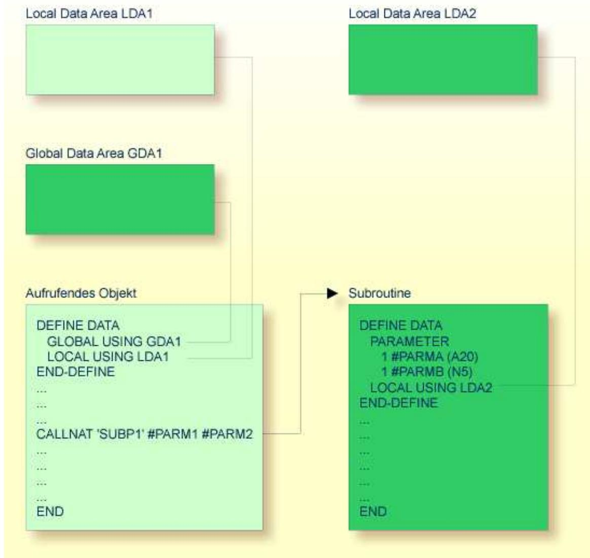
Außerdem kann ein Subprogramm eine eigene Local Data Area haben, in der die Felder definiert sind, die innerhalb des Subprogramms verwendet werden.
