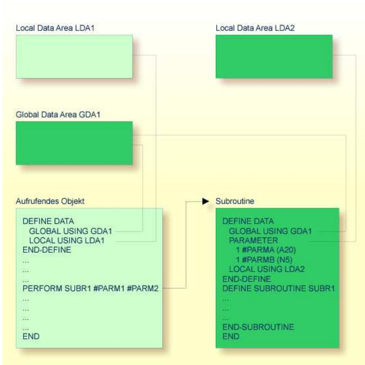
Eine externe Subroutine — also ein *Objekt* vom Typ Subroutine — kann nicht selbständig ausgeführt werden. Sie muss von einem anderen Objekt aufgerufen werden. Das aufrufende Objekt kann ein Programm, eine Function, ein Subprogramm, eine Subroutine oder eine Helproutine sein.
