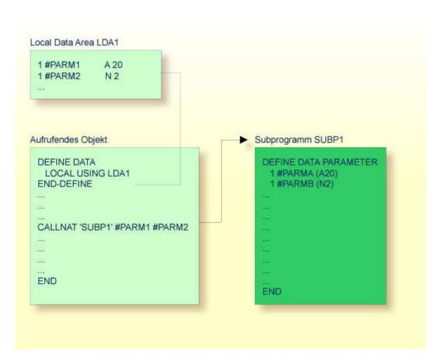
Separat in einer Parameter Data Area definierte Parameter
