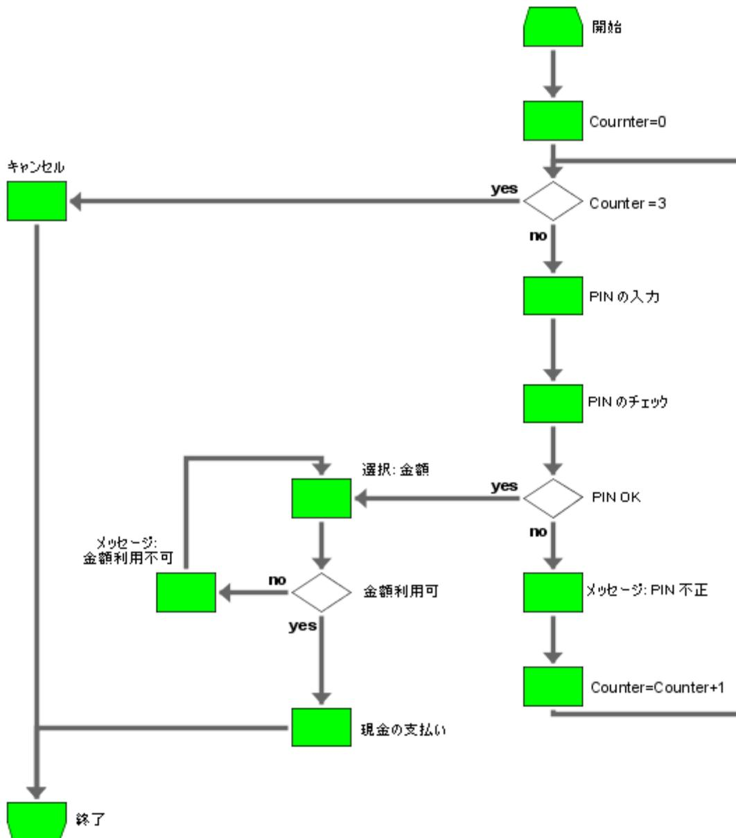
図 101: プログラム フロー図 (PF) の例
