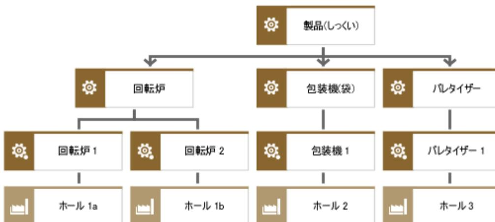
図 66: [技術的リソース] モデルの例
